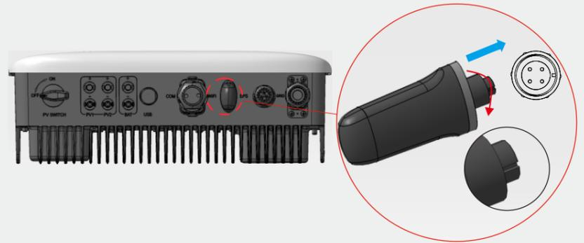
Insérez le dongle Wi-Fi inclus dans le kit d'accessoires situé à la base, puis serrez l'écrou en plastique à  $2,5 \pm 0,5$  N-m.
