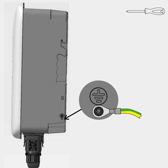
REMARQUE : La vis PE est préinstallée sur le convertisseur hybride et doit être serrée à  $2,5 \pm 0,5$  N-m.
