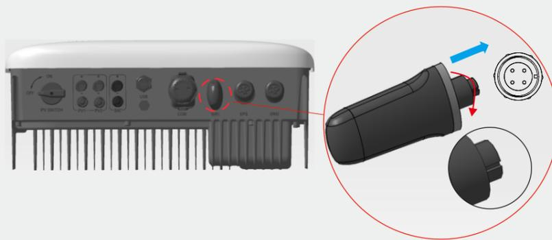
Den im Zubehörpaket enthaltenen WLAN-Dongle in den Sockel einstecken und die Kunststoffmutter mit  $2,5 \pm 0,5$  Nm anziehen.
