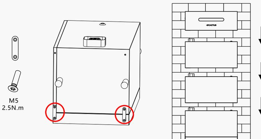
\*Bitte sichern Sie die Verbindungsplatten an jeder Batteriebox, bevor Sie diese stapeln, und verwenden Sie Hebeausrüstung bei der Installation der sechsten Batteriebox.
