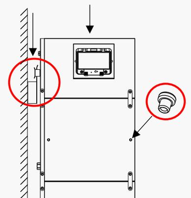
\*Bitte stellen Sie sicher, dass die Hochspannungsbox zuverlässig angeschlossen ist.
