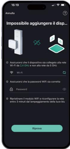
**Passaggio 6:** È anche possibile configurare la rete tramite l'hotspot del dispositivo. Per fare ciò, accedere alle impostazioni WLAN per collegare l'hotspot del dispositivo, quindi tornare in questa pagina. La connessione si avverrà automaticamente.
