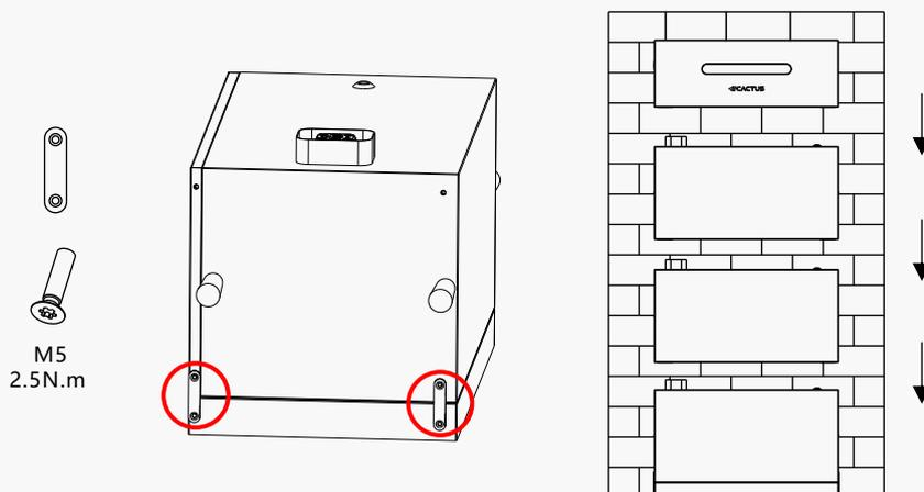
\*Si prega di fissare le piastre di collegamento su ciascun vano batteria prima di impilarle e di utilizzare attrezzature di sollevamento quando si installa il sesto vano batteria.
